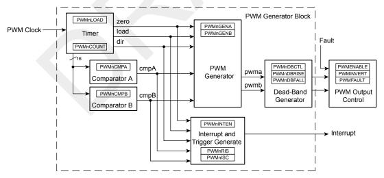
Figure 16-1. PWM Module Block Diagram
